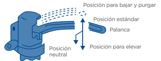
Empuje la palanca hacia arriba cuando el levantamiento esté inactivo o no esté en posición de levante, realice varios movimientos de bombeo hasta su límite y sostenga firmemente la palanca. Cuando esta baje la bomba se purgará a través de la válvula de liberación.
