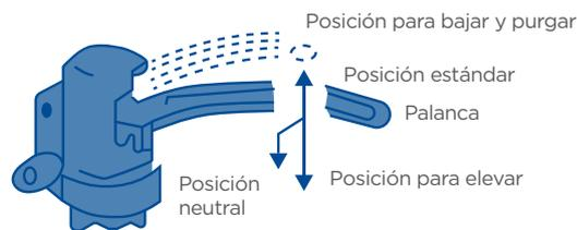
Empuje la palanca hacia arriba cuando el levantamiento esté inactivo o no esté en posición de levante, realice varios movimientos de bombeo hasta su límite y sostenga firmemente la palanca. Cuando esta baje la bomba se purgará a través de la válvula de liberación.
