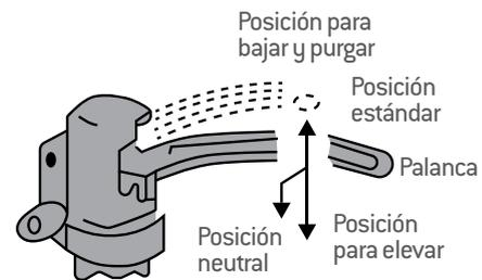
Empuje la palanca hacia arriba cuando el levantamiento esté inactivo o no esté en posición de levante, realice varios movimientos de bombeo hasta su límite y sostenga firmemente la palanca. Cuando esta baje la bomba se purgará a través de la válvula de liberación.
