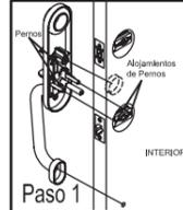
Alinear los postes del gatillo y el perfil cuadrado a los alojamientos en el pestillo, asegúrese que la base del Gatillo coincida con el barreno de sujeción inferior. El cilindro de bloqueo quedará alojando en el barreno ciego.
