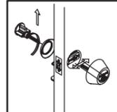
Alinear el cilindro y la roseta exterior para cerrojo una vez hecho esto alinear la lengüeta del cilindro en forma vertical por la parte exterior y centrarla con la ranura del pestillo, así mismo alíne en forma horizontal las lengüetas en el cilindro interior e inserte en el pestillo.
