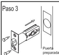
Deslice el pestillo en la perforación por el canto de la puerta como se indica en la figura y después fije a la puerta con las pijas para madera
