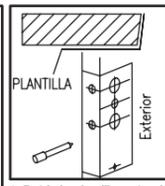
1. Doble la plantilla sobre la línea marcada y coloque en el canto de la puerta a la altura adecuada (40" del piso al gatillo). Si su puerta es biselada, coloque la plantilla en el lado mas bajo del bisel como se muestra. Marque.
