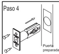
Deslice el pestillo en la perforación por el canto de la puerta como se indica en la figura y después fije a la puerta con las pijas para madera
