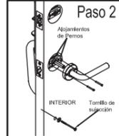
Coloque la manija asegurándose que el perfil cuadrado entra por el centro de la manija. Coloque el tornillo de sujeción inferior centrándolo al alojamiento de la base en el Gatillo. Atornille y ajuste firmemente.
