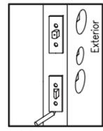
2. Coloque ambos pestillos en el canto de la puerta. Copie el borde del frente de cada uno de los pestillos sobre el canto. Marque las perforaciones de los tornillos de  $1/8"$ .
