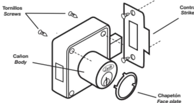
Realizar perforación con broca de 7/8" (22,2mm) para el paso del cañon desde el interior del mueble.
