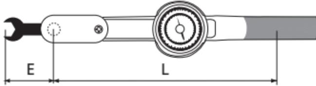
Un número de variables incluyendo la longitud el adaptador o de la extensión, la longitud del torquímetro y las variaciones en la posición de la mano, afectarán la precisión del cálculo anterior.
