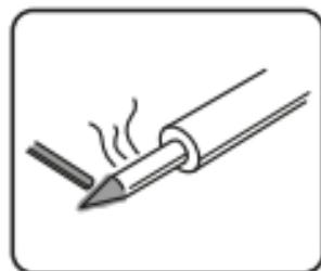
Las puntas de soldadura son de cromo galvanizado en la superficie y deben ser de color plata brillante sin residuos o soldadura sobre él.
