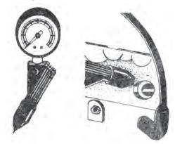
2. Ponga en marchar el motor de automóvil hasta que el probador alcance su lectura máxima; registre el valor y el número de revoluciones necesarias. Crank the engine until the tester reaches its highest reading; note the value and the number of revolutions necessary.
