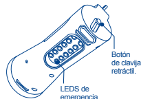
LEDS de emergencia.
