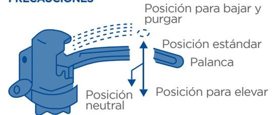
Empuje la palanca hacia arriba cuando el levantamiento esté inactivo o no esté en posición de levante, realice varios movimientos de bombeo hasta su límite y sostenga firmemente la palanca. Cuando esta baje la bomba se purgará a través de la válvula de liberación.
