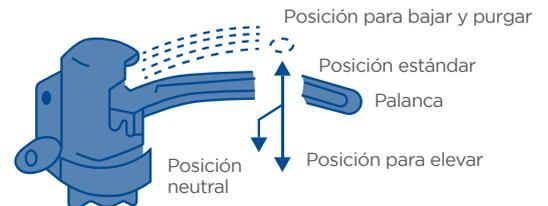
Empuje la palanca hacia arriba cuando el levantamiento esté inactivo o no esté en posición de levante, realice varios movimientos de bombeo hasta su límite y sostenga firmemente la palanca. Cuando esta baje la bomba se purgará a través de la válvula de liberación.
