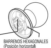
NOTA: Antes de instalar la unidad INTERIOR verifique que el mecanismo del chasis esté alineado con el de la unidad exterior como se muestra en la ilustración.
