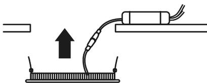
5. Coloque levantando los sujetadores y de manera horizontal, el luminario como se muestra en la imagen.
