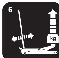
Al estar dotado con el sistema del principio "hombre muerto", la palanca, una vez suelta, retorna automáticamente a su posición inicial, con lo que el gato está listo para funcionar.
