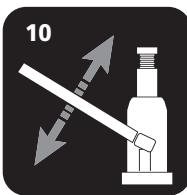
Para descender, gire lentamente la llave de descarga con la palanca en sentido contrario a las agujas del reloj (6), asegurándose de que no haya personas u obstáculos debajo del vehículo que desciende. La velocidad del descenso queda regulada por la mayor o menor apertura de la llave de descarga.
